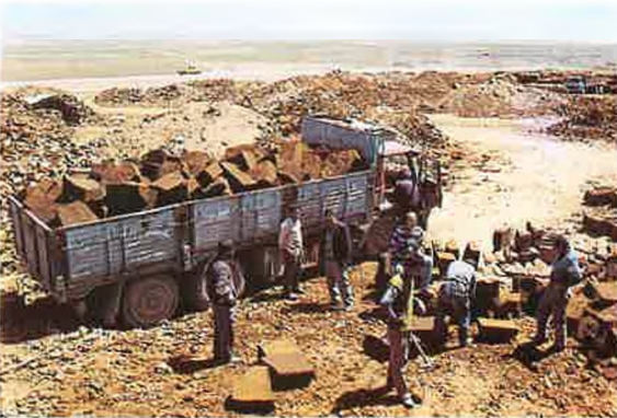
Res. 23: Karhane Taş Ocağında taşın yüklenmesi.
