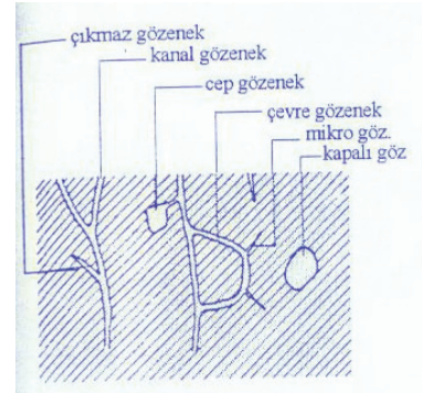
Şekil 3. Taşlardaki porozite türleri (Torraca, 1988).
